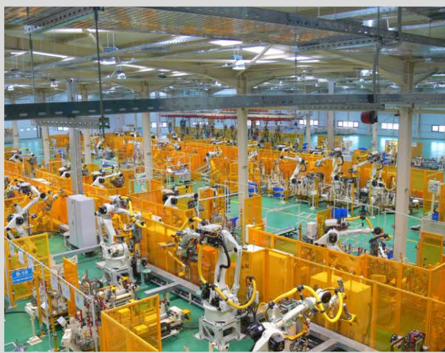
Kaynak Hattı (Robotlar) / Weld Line (Robots)
